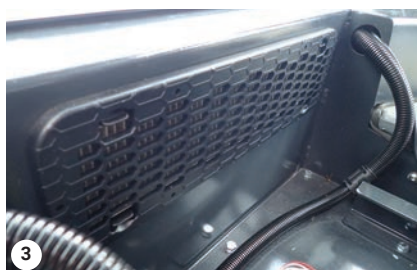
Resirkulasjonsfilter bak setet
