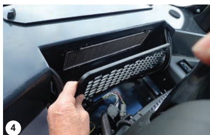
Resirkulasjonsfilter bak setet
