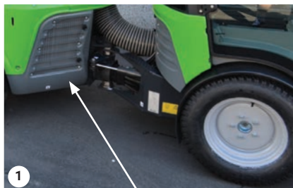
Deksel for tilgang ved radiator
