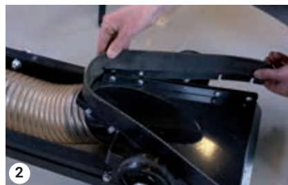
Monter den nye gummiprofilen
