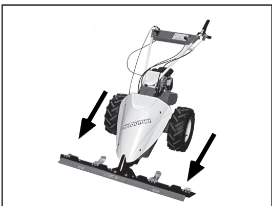
Differensiallås for fartsretning rett fram (fast aksel)
