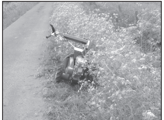
Bruk høydejusteringen på styret ved høy vegetasjon og ellers når nødvendig
