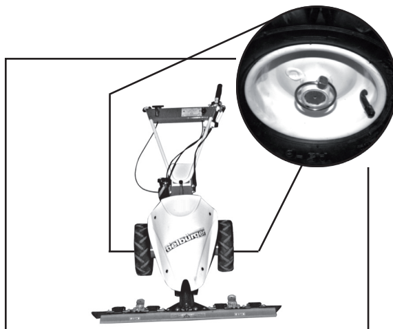
Låsepinnen i posisjon som vist = vendehjelpen ikke i funksjon
