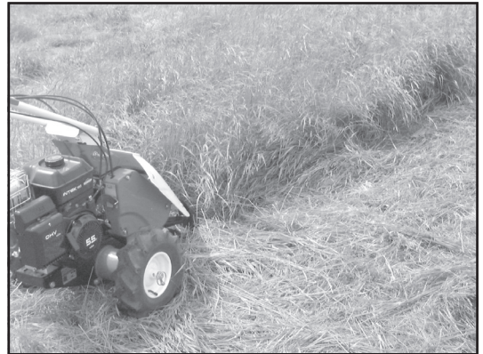
Rektangulær klippemetode = avklippet gir god spredning
