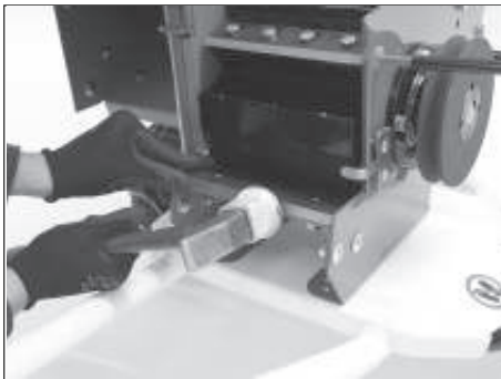
Juster kutteskiven ved å flytte kutteskiveholderen over sporene. Klaringen mellom knivene og kutteskiven skal være 0,5 - 1 mm.
