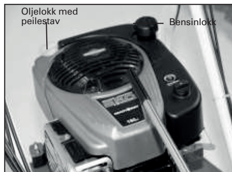
1) Bensin- og oljetank på B&S motor.
