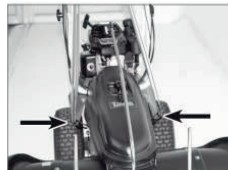
4) Riktig montert løftekrok. Bruk samme fremgangsmåte på andre siden.
