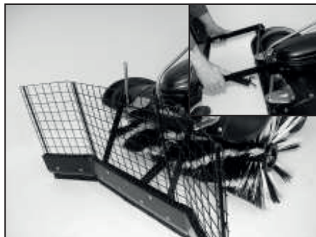
2) Plasser løvsamleren på festeanordningen og sett på nettingplaten.
