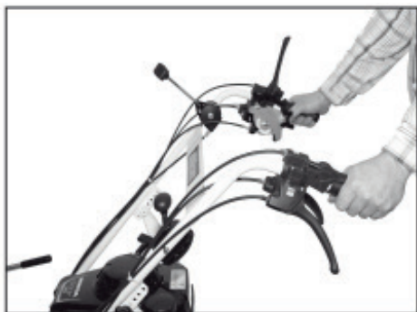
1) Hendlene for fremdrift og børster finner du på håndtaket.
