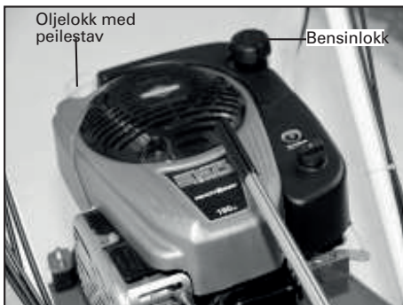
1) Bensin- og oljetank på B&S motor.
