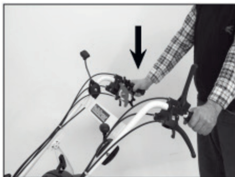
2) Clutch-hendelen for fremdrift er øverst på høyre side av håndtaket.
