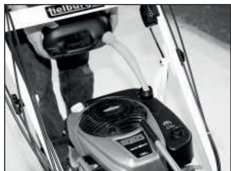
2) Hold bensinkannen som vist på bildet over. Fyll på i små mengder og kontroller bensinnivået hver gang.
