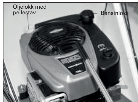
1) Bensin- og oljetank på B&S motor.
