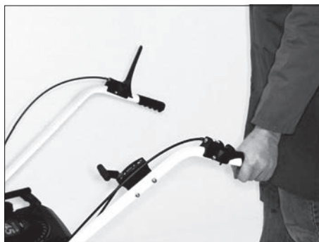
2) Clutch-hendelen for fremdrift er øverst på venstre side av håndtaket.
